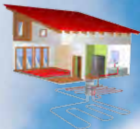
Warmtebron aardbodem middels gesloten horizontale bodemwarmtewisselaar.
