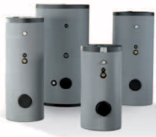
Vorraadvaten van 200 tot 800 liter voor vloermontage vervaardigd uit geëmailleerd plaatstaal en titanium anode, inclusief 2 kW elektrisch element.
